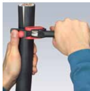
Otažení nástroje pro obvodový řez
