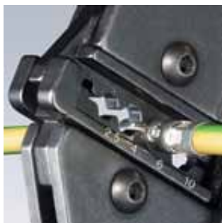
97 43 200 s profilem 97 49 30 pro lisování neizolovaných kabelových spojek
