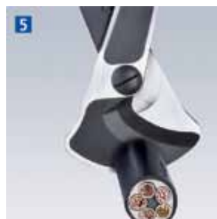
Opakujte řez a rozevření, až je kabel přestřípnutý.
