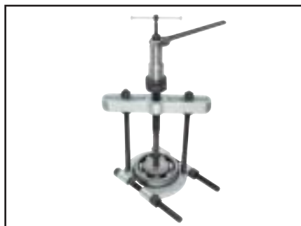
Stahovací přípravek 18-4 s hydraulickým šroubem 8-1-B a oddělovačem 15-4
