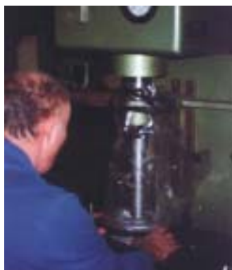
Hydraulický dílenský lis při používání s protiúrazovou krycí plachtou č. UFP-2. Krycí plachta obepíná pracovní oblast. Pracovní proces lze od začátku do konce pozorovat a kontrolovat.
